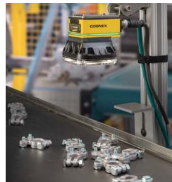
Abbildung 1. Menschliche Prüfer sind qualifiziert, am Beispiel zu lernen und Fehler von akzeptablen Abweichungen zu unterscheiden. Industrielle Bildverarbeitung hingegen bietet eine Geschwindigkeit und Robustheit, die nur ein computerbasiertes System bieten kann.
