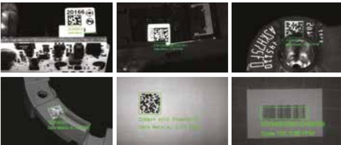
1DMax avec technologie Hotbars permet une lecture à grande vitesse des codes-barres 1D endommagés et mal imprimés ne dépassant pas les 0,8 pixels par module (PPM).
