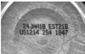
Image de caméra monochrome avec éclairage bleu
