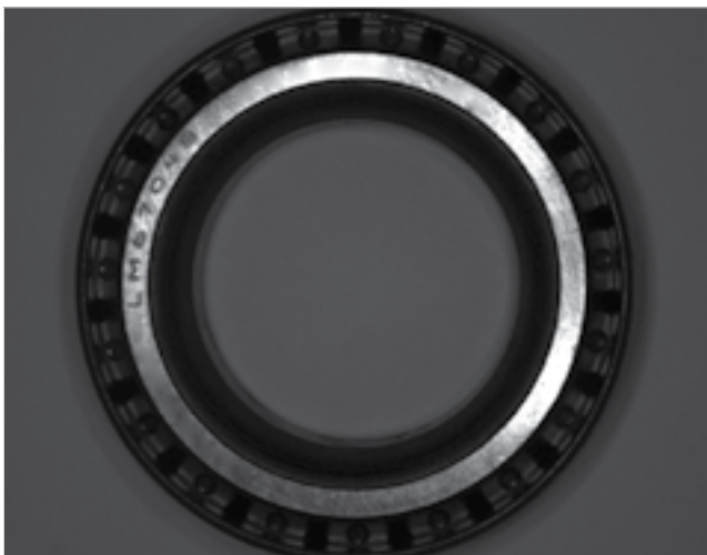
Sans technologie HDR : Pièces encastrées illisibles.
