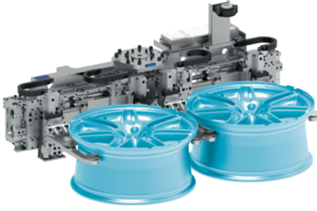
Doppelgreifeinheit zum Umsetzen von Felgen
